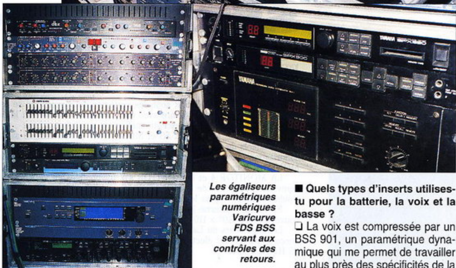
Une partie des effets et contrôles utilisés par Pierre Jacquot : dbx 166 (hors mix), compresseurs DPR 402 BSS, noise-gates Drawmer DS 201, égaliseurs DN 360 Klark Teknik, processeur d'effets Yamaha SPX 990 et Lexicon PCM 70, égaliseurs Varicurve BSS et filtre-ligne de retard D 2040 Yamaha.
